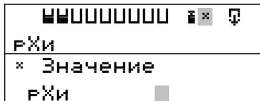
Прибор перейдёт в режим ввода значения изопотенциальной точки. Значение приведено в паспорте на стеклянный или комбинированный электрод. Допустим, для определённости, что в паспорте указано значение  $pH_i=7,00$ .
